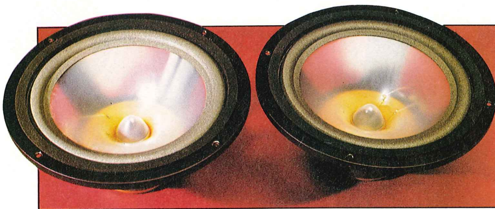
La gamma bassa è riprodotta da una coppia di woofer, di uguali caratteristiche, tagliati tra loro a 60 Hz. Da notare le membrane in polipropilene, un materiale molto leggero, ma sufficientemente rigido.
